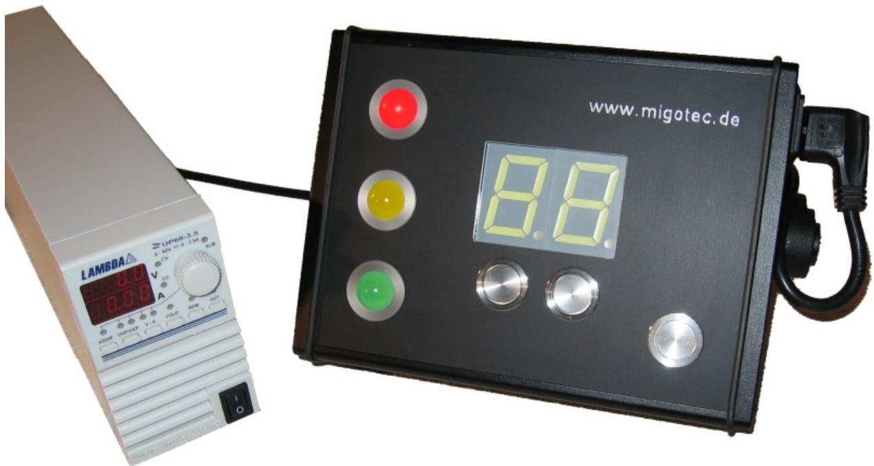
**Bedientableau für die Fertigung und Qualitätssicherung mit Leucht- und Akustikmelder, Segmentanzeige und vandalismussicherem Bedienfeld. Frei programmierbare Industriesteuerung zum Anschluss an alle programmierbaren ZUP Stromversorgungen.**
